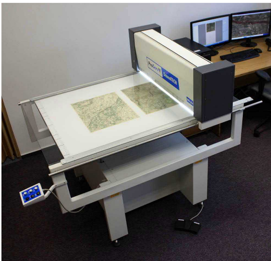
Obr. č. I.1.2. Velkoformátový skener ScannTech 800i firmy Proserv, který byl pořízen v rámci projektu a který splňuje výše uvedené požadavky.
