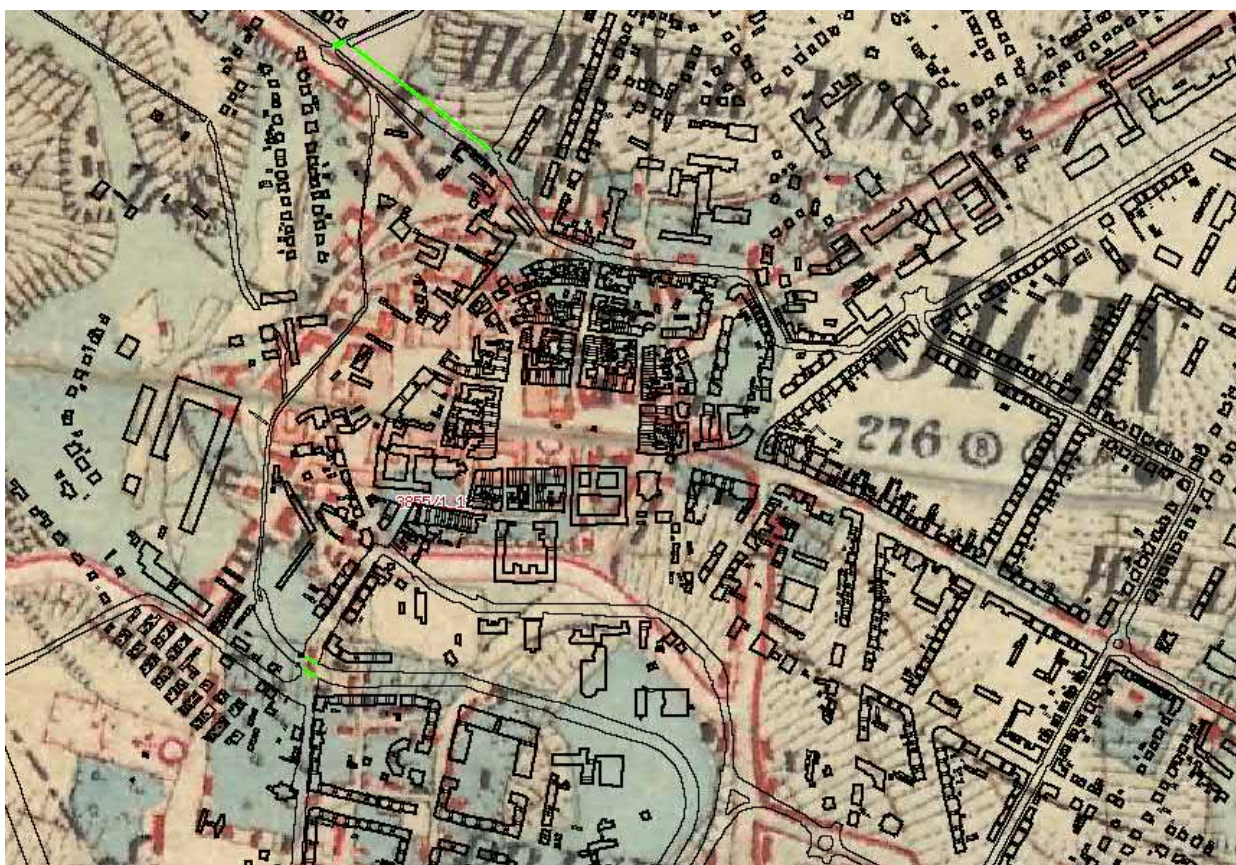
Obr. č. I.3.2. Překryv staré mapy III. vojenského mapování a nové mapy (georeferencování provedeno standardní transformací využívající jen rohů mapových listů).
